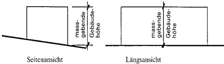
Abb. 7. Messen der Gebäudehöhe bei Gebäuden mit Attika (§ 18 Abs. 3)
